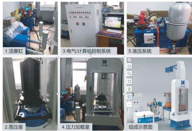
图 2 ZYSS2000型三轴试验装置组成
