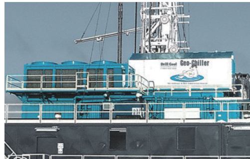
图1 DrillCool公司研制的钻井液冷却装置
