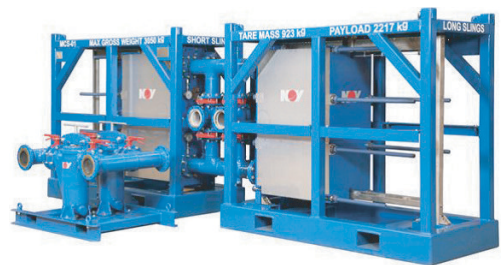
图2 NOV公司的钻井液冷却系统
