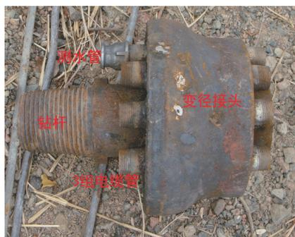
图3 下层水管内止封器实物
