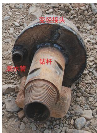
图5 上层水管内止封器实物
