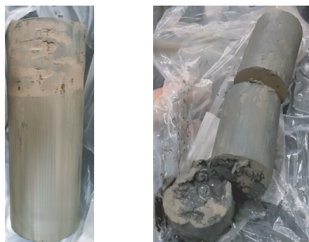
(a) 粘土样的受拉扰动 (b) 夹粉土粘土样的自发断裂
