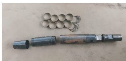
(a) 内置环刀取土器(环刀等结构部件)
