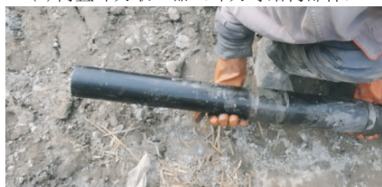
(b) 敞口薄壁取土器(薄壁取样管等结构部件)
