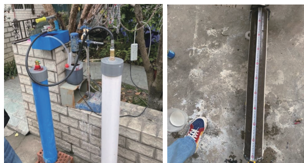
图4 一维模拟灌浆实验
