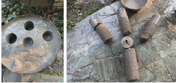
图5 二维模拟灌浆实验取心效果
