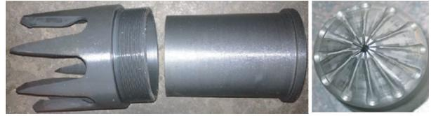
图 2 导向套+全封闭岩心爪
