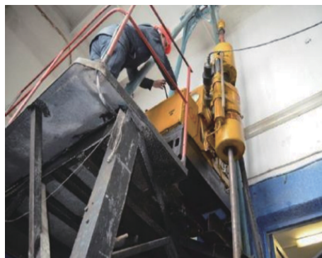
图 4 用 CKB-4 型钻机改装的试验台
