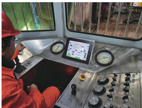
图3 XY-9DB钻机司钻房实物图片
