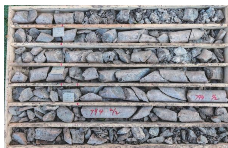
图4 绳索取心液动锤钻进取出的岩心
