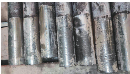
图4 钻孔弯曲引起的管柱磨损
