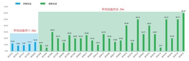
图 6 绳索钻进工艺与单管钻进工艺施工效率
