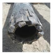
(a) 圆形底喷水口钻头
