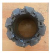
(b)长条形底喷水口钻头 图 5 优选取心钻头
