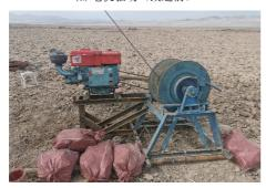
(b) 柴油机驱动(改造后) 图7 绳索取心绞车
