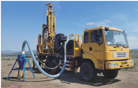
图9 TGQ-200RC型钻机现场试验
