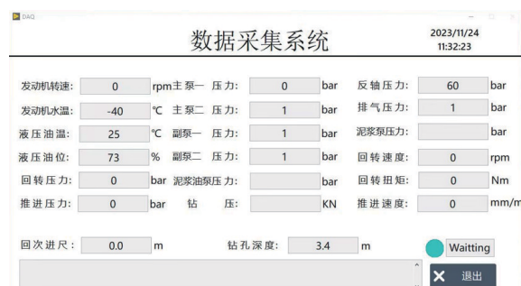
图7 钻机参数监测界面
