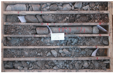
图6 五开2842~2846 m严重破碎地层
