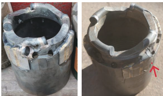
图4 阶梯式取心钻头使用前后照片
