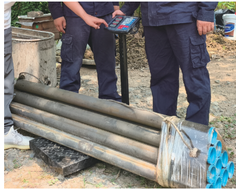
图3 吊运单元现场称重
