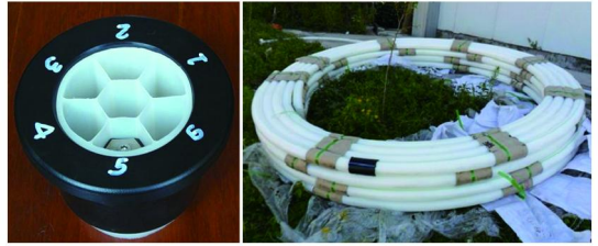
图2 多通道管的断面形状及成品
