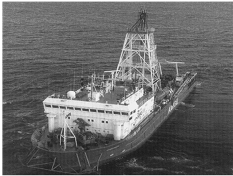
图 9 惠固公司的钻探船 (船长 85.5 m、船宽 16.8 m、船的作业水深 13 ~ 3000 m)
