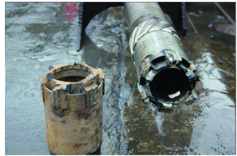
图8 改进后的PDC复合片取心钻头
