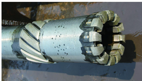
图7 电镀孕镶金刚石取心钻头
