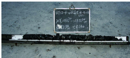
图 1 2K-QX22 回次取出的破碎岩心
