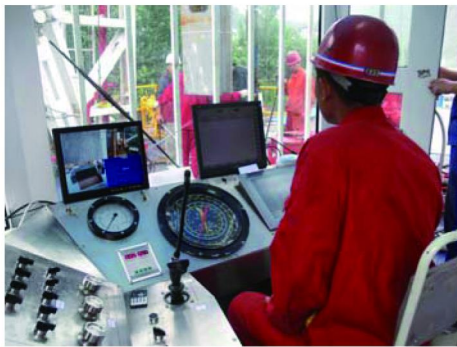
图6 KZ-30-DB型钻机司钻室
