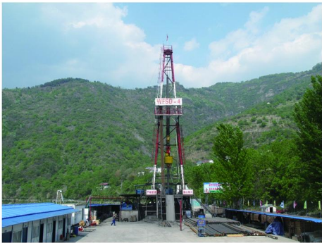
图 7 KZ-30-DB 型钻机在 WFSD-4 孔现场应用
