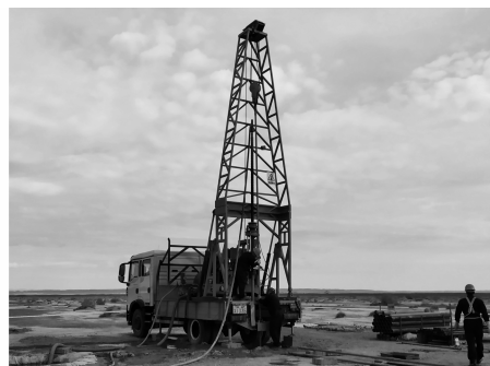
图3 DPP-300型车载钻机在戈壁荒漠上施工作业
