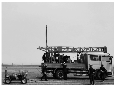
图3 DPP-300型车载钻机在戈壁荒漠上施工作业
