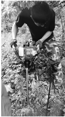
图5 采用背包钻“以钻代槽”开展工作
