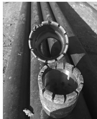
图4 \varnothing 108 mm孕镶金刚石钻头
