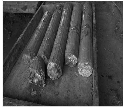
图2 使用X-A成膜剂低固相泥浆采取的土层、砂层岩心
