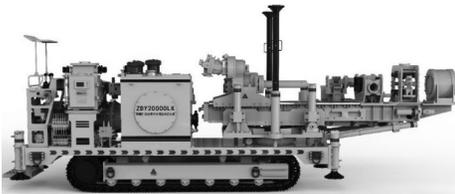
图4 煤帮大直径防冲自动化钻机
