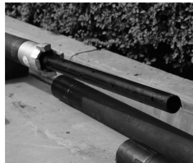
图9 不提钻下筛管护孔技术原理
