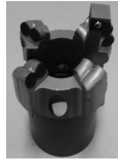
图8 可开闭式钻头
