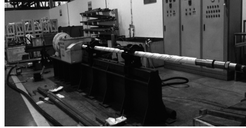
图10 空气螺杆马达室内测试
