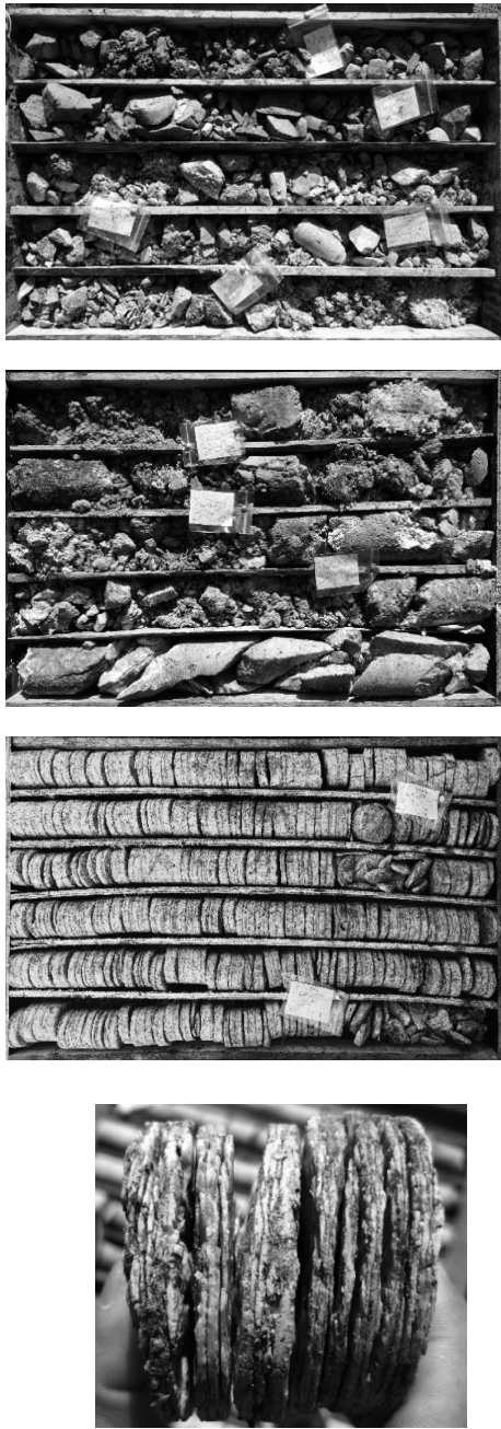
图5 破碎地层和高应力地层的部分岩心
