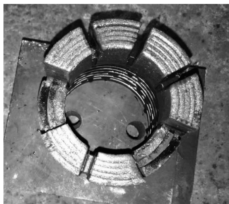
图7 18号钻头胎体脱落
